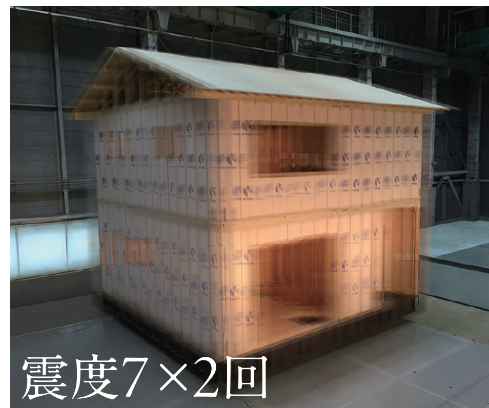
三次元実大振動実験（2016年5月6日大林組技術研究所にて実施）
