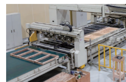
組み立て(フレーム材・構造用面材)
